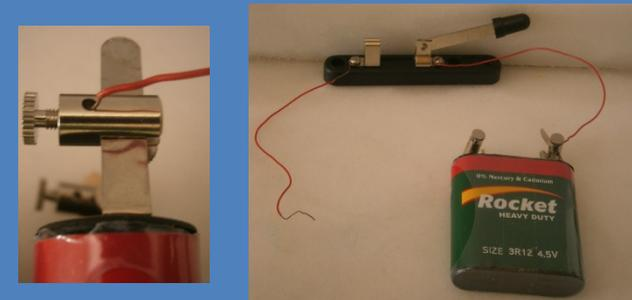
Liga um dos fios do interruptor a um dos polos da pilha, desaparafusando e voltando a aparafusar o parafuso.
