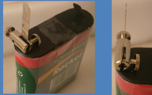
Introduz os 2 parafusos, pela ranhura, nos 2 polos da pilha e aparafusa para ajustar as ligações.
