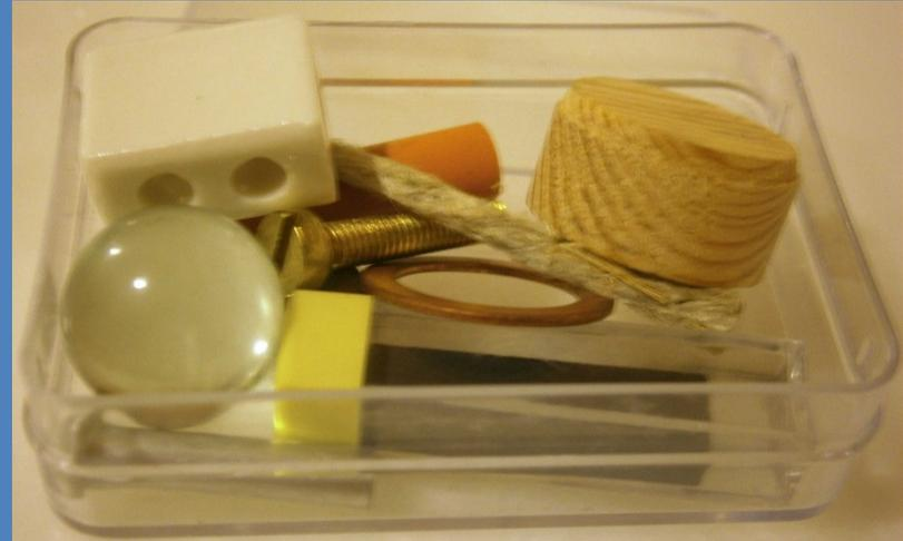
**Vários materiais:** disco madeira, rebite de alumínio, anel cobre, prego ferro, pedaço de corda, berlinde vidro, barra carbono e barra de borracha, parafuso bronze, pedra, pedaço porcelana
