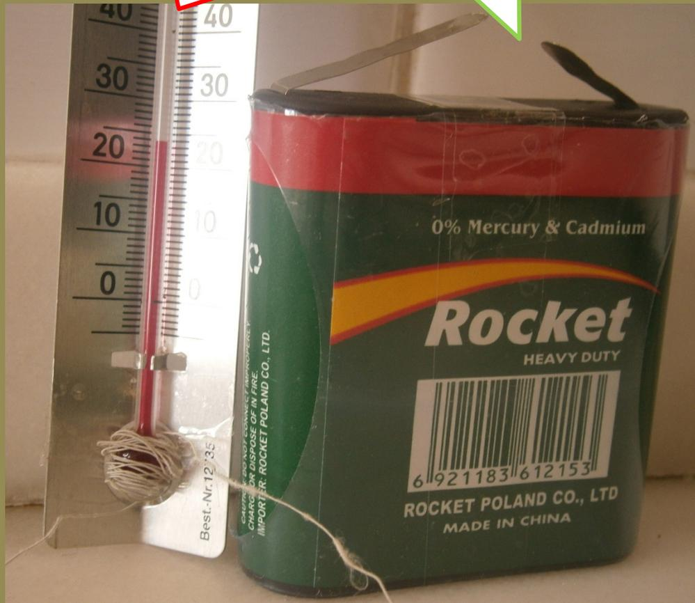
**Consegues montar um circuito simples para observar o aumento de temperatura num fio elétrico onde passa a corrente?**
