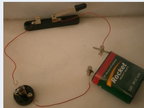
Para o circuito fechar é necessário ligar um fio eléctrico da pilha ao suporte da lâmpada.
